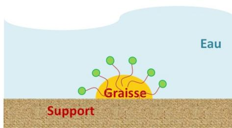
Figure 1 : Action d'un tensioactif
