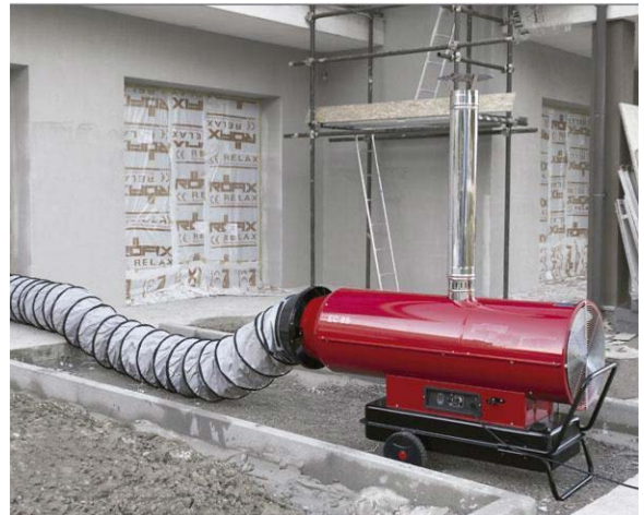
Chauffage diesel portable équipé d'une extraction pour les fumées d'échappement
