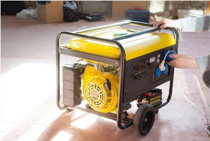
Générateur électrique diesel portable
