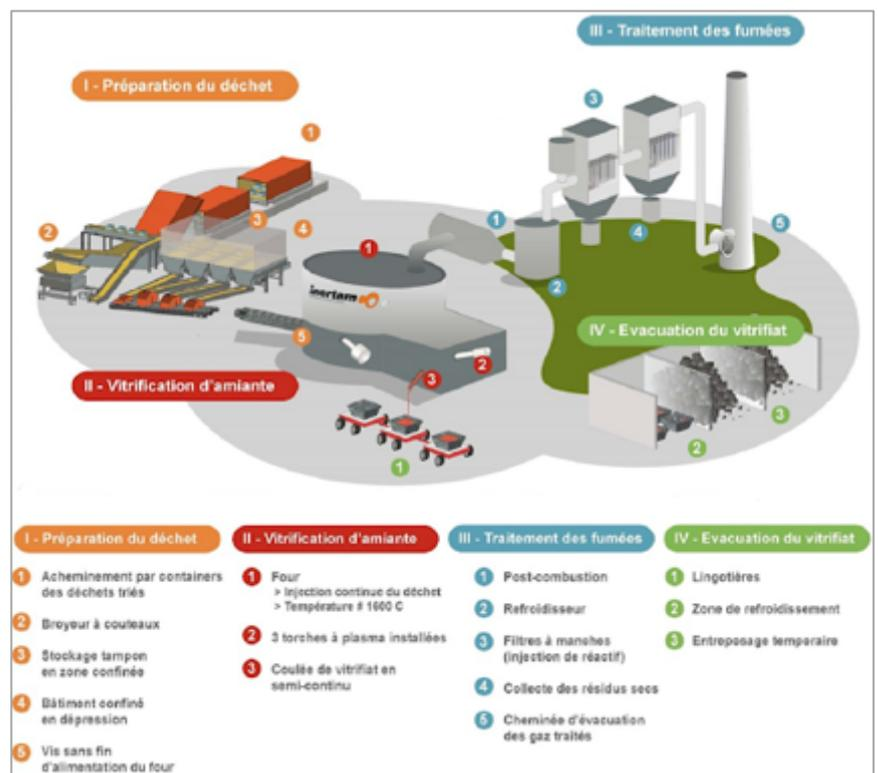
Figure 19: Processus de traitement de l'amiante par vitrification. Source : inertam.co
